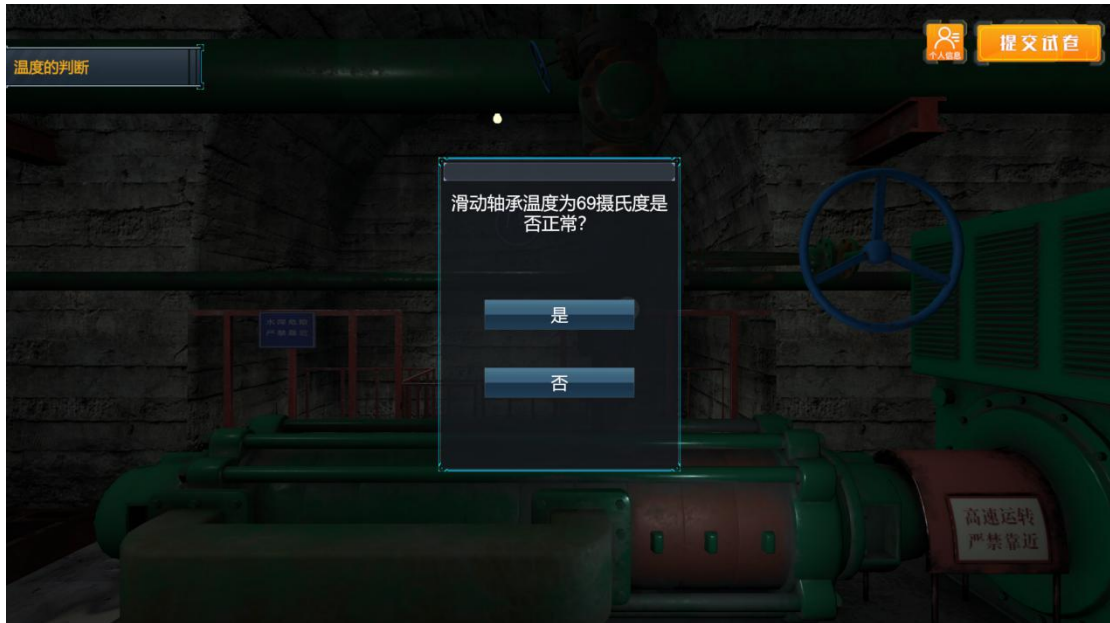
电机温度的判断（PS：电机温度不可以超过 70 摄氏度）
