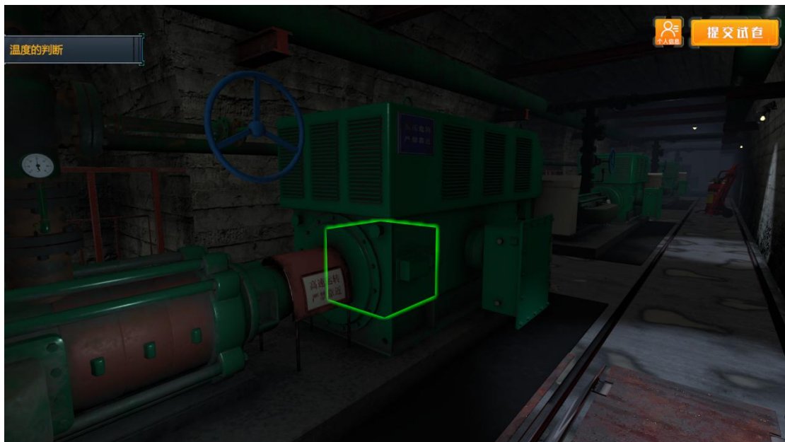
电机温度的判断（PS：电机温度不可以超过 70 摄氏度）
